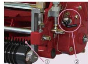
①正転、逆転が可能なフロントグレーマー (LM56GBF、LM66GBF) ②リールカッターの回転を変えるハイ・ロー切替レバー
