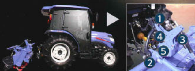
吊り上げるだけのワンタッチマッチング。
